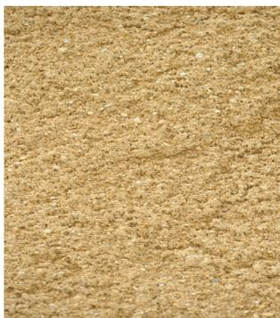
Frostsicherer, kalk- und kaolinfreier Quarzsand, frei von Huminstoffen und Verunreinigungen
