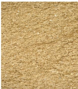
Naturfarbener, frostsicherer, kalk- und kaolinfreier Quarzsand, frei von Huminstoffen und Verunreinigungen
